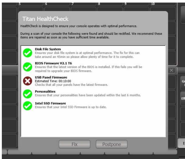
Ejecuta las correcciones solo si dispones de mucho tiempo, ya que algunos arreglos pueden tardar hasta una hora en completarse.
