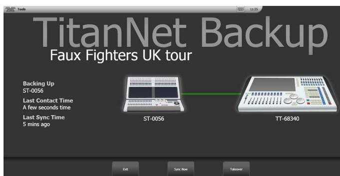
La línea verde entre consolas representa una buena conexión. Una línea roja significa que hay un problema con la conexión. Una línea azul aparece durante operaciones de sincronización.
