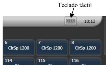
El teclado emergente se puede cambiar de tamaño mediante el botón MAX/MIN y cerrarlo con el botón X de la esquina superior derecha. Se puede configurar para que emerja automáticamente cuando se entra texto utilizando el botón Man/Auto. También se puede mover tocando y arrastrando el área blanca de la parte superior.
