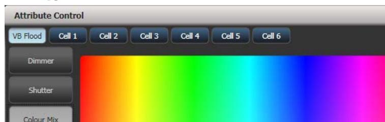
Para acceder a los sub aparatos independientemente, pulsa Unfold y a continuación el botón selector del aparato. En la ventana Fixtures, la actual página de aparatos será reemplazada por botones de selección para cada una de las celdas individuales. En los preset faders, se despliegan las celdas empezando por el preset 1.
