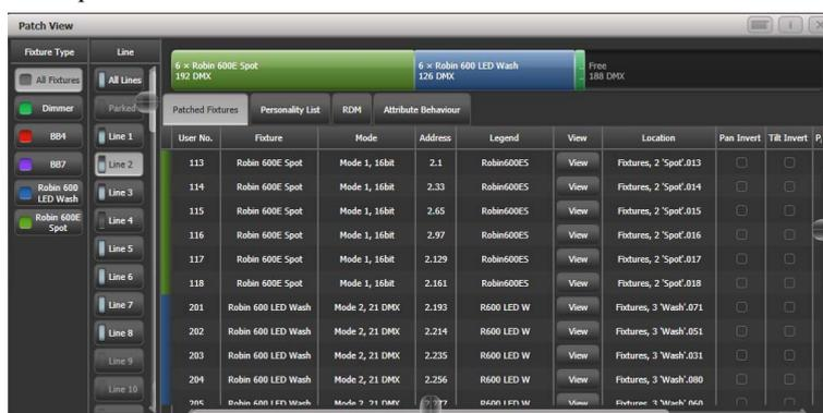
**Fixture type:** lista de los diferentes tipos de aparatos contenidos en el show. Cada aparato está codificado con un color único. Pulsa en estos botones para seleccionar todos los aparatos de ese tipo.
