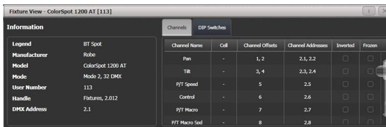
Si los aparatos se direccionan mediante DIP switches, la consola puede mostrar como configurar los interruptores, haz clic en la pestaña DIP Switches.
